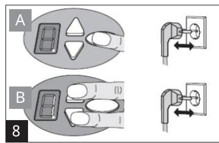
**A:** Ponjištavanje programiranih daljinskih upravljača: Isključite struju/pritisnite i držite pritisnutu desnu tipku/isključite utikač u struju/pustite desnu tipku
